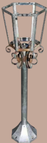
Vorher: Deutliche Korrosions- schäden
